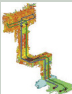
Рис. 3. «Облако точек» и векторная 3D-модель из примитивов
